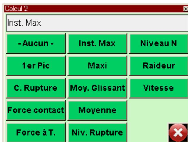
1<sup>er</sup> Pic : Calcul la première rupture détectée par le capteur. Vous pouvez définir sur quelle voie s'effectue le calcul et le pourcentage de chute de la force par rapport au maximum qui déclenchera le calcul. Toute autre rupture après la première sera ignorée.
