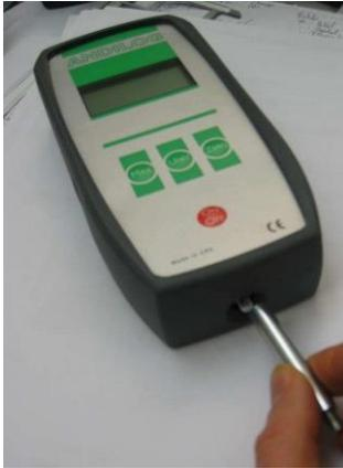
Conecte el cable alargador suministrado en el maletín a la varilla de la célula de carga situada en la parte inferior del dinamómetro. El apriete debe hacerse a mano sin aplicar un par de apriete elevado. Un par de apriete excesivo o el uso de alicates pueden dañar el sensor.
