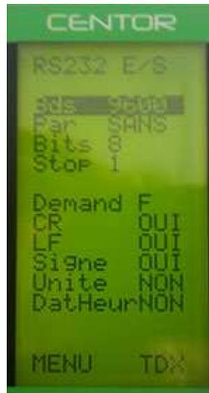
La première partie de l'écran correspond aux paramètres de la transmission Rs232 et sont modifiables grâce aux touche ZERO et TDX. Ils doivent être identiques à ceux de l'ordinateur auquel le Centor Easy est connecté.
