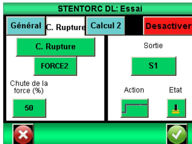
Dans le menu « affichage », choisissez « FORCE2 » et « Rupture » pour l'affichage principal et si vous souhaitez connaître le déplacement à la rupture « Deplac1 » et « Pic » pour l'affichage auxiliaire.
