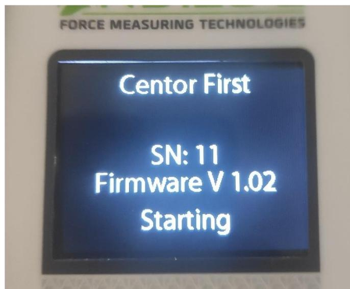
Après l'autotest, si l'appareil est fonctionnel, le couplemètre affiche l'écran de mesure. Il affiche alors 0 Nm. Une tare est effectuée au démarrage de l'appareil.
