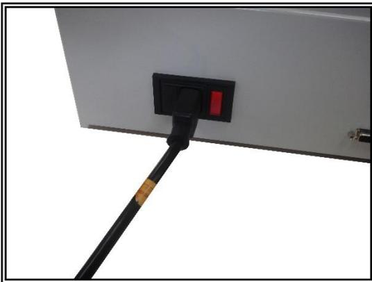
Connectez le câble secteur fourni à l'arrière du couplemètre. Appuyez sur le bouton rouge pour mettre en marche la charge de l'appareil. La led verte doit s'allumer sur la façade de l'Anditork First si la batterie charge.
