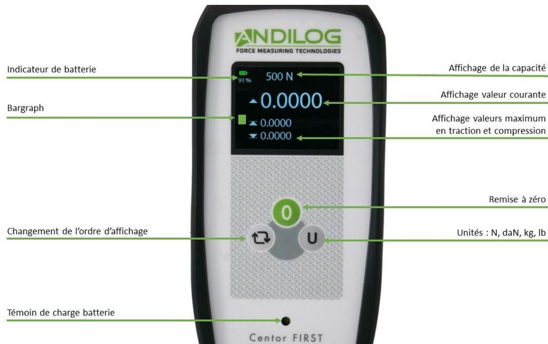
**Indicateur de batterie :** varie entre 0% et 100% pour indiquer l'autonomie de la batterie. Quand la batterie est neuve l'autonomie est de 15h environ en utilisation continue. Quand le pourcentage de batterie atteint 0% le couplemètre s'éteint.
