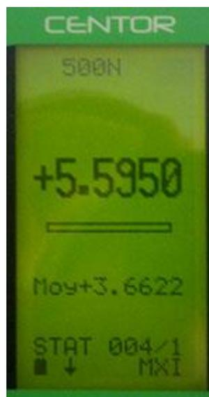
La misura viene effettuata esercitando una forza sul sensore di pressione Centor. In qualsiasi momento il massimo viene visualizzato in caratteri grandi.
