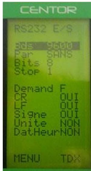
La prima parte dello schermo corrisponde ai parametri della trasmissione Rs232 e può essere modificata con i tasti ZERO e TDX. Devono essere identici a quelli del computer a cui è collegato il Centor Easy.
