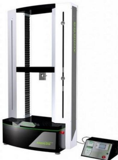
La gamme ATLAS II CC est constituée de machines d'essais bi-colonnes de traction et compression avec des capacités allant jusqu'à 50 kN. Ce sont des machines de table polyvalentes permettant de s'adapter à tout types d'essais de matériaux et échantillons.
