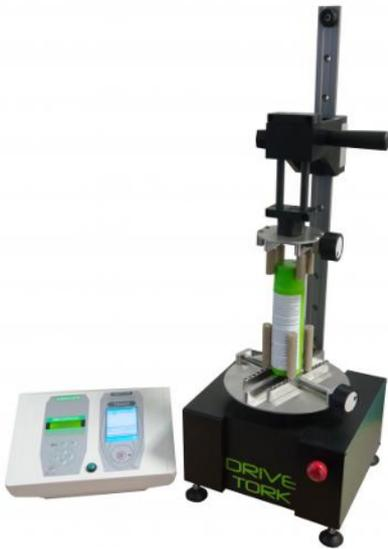
Pour réaliser une mesure de couple précise et répétitive, il est souvent nécessaire d'utiliser un banc de torsion disposant d'une **vitesse constante programmable**. Le torsiomètre motorisé vertical Drivetork permet de réaliser ses mesures en s'affranchissant de l'influence de l'opérateur grâce à une rotation régulée à vitesse constante.
