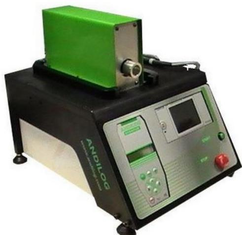
Le banc de torsion motorisé TorkHeaDriver est un couplemètre dynamique motorisé permettant d'effectuer des **mesures de couple et d'angle facilement sur des systèmes complets**. Ce torsiomètre est particulièrement bien **adapté aux mesures sur les boutons rotatifs, les potentiomètres, les vannes etc. installés sur des ensembles**.
