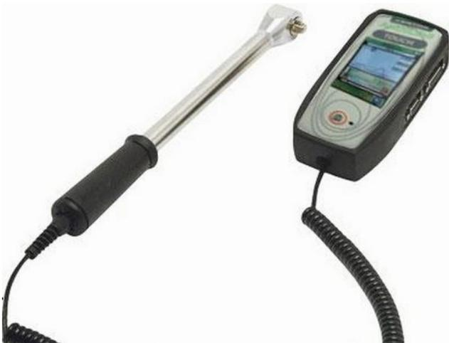
L'afficheur Centor Star Touch dispose d'une électronique puissante conçue pour faciliter les mesures.
