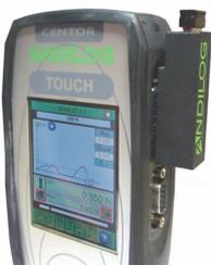
Le logiciel Datastick II et sa clé USB vous permettent de sauvegarder automatiquement ou à la demande les résultats (calculs, statistiques) et les courbes de vos tests sur une clé USB de votre choix. Le logiciel inclus vous permet de visualiser les courbes et les données de mesure sur votre ordinateur et bénéficie des performances de Caligraph.
