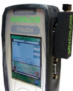
Der einfach zu bedienende Datastick II wird mit einem mitgelieferten Adapter in den Stecker Ihres Gehäuses gesteckt und die Konfiguration erfolgt über die Benutzeroberfläche Ihres Messgerät.
