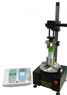
Drivetork , automatisierte Drehmomentmessungen
