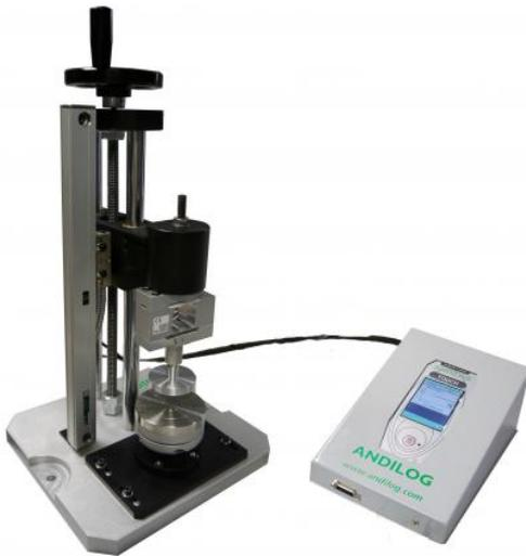
Der Springtest 2 wurde speziell für die genaue Messung von Druckfedern entwickelt. Dieser manuelle Prüfstand mit Kraftanzeige und Wegmesssystem ist besonders gut für die Messung von Federn mit kleiner Abmessung und die Überprüfung von Bauteilen geeignet.
