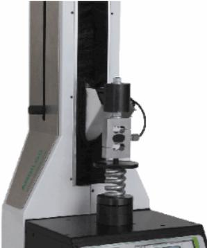
Der Springtest 3 wurde auf der Basis vom Stentor II konzipiert und verfügt über die neuesten Technologien für die Kraftmessung. Er ist die ideale Lösung für die Kontrolle von Zug- und Druckfeder von 0 bis zu 2000 N.
