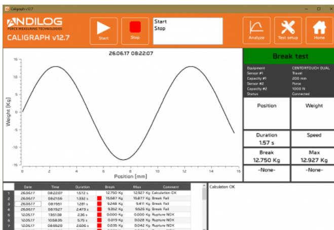
Der Springtest 2 ist mit der Datenerfassung und Analyse-Software Caligraph geliefert. Mit Caligraph können Sie den Kurvenverlauf Ihrer Kraft- und Drehmomenttests visualisieren, Ihre Daten speichern, die Testergebnisse automatisch berechnen und personalisierbare Berichte erstellen.
