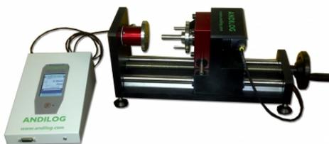
**Twist** - Manuelle Messung des Winkels und des Drehmoments
