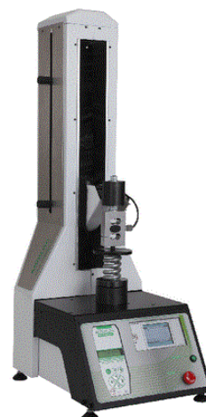
Springtest 3 - Automatisierte Messungen
