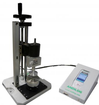
Springtest 2 - Micrometeregenaue Messungen
