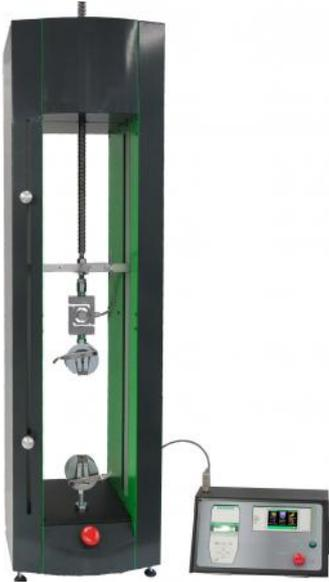
Der Wiretest 3 Prüfstand wurde entwickelt, um die Crimpqualität von Kontakten mit großem Durchmesser zu überprüfen.
