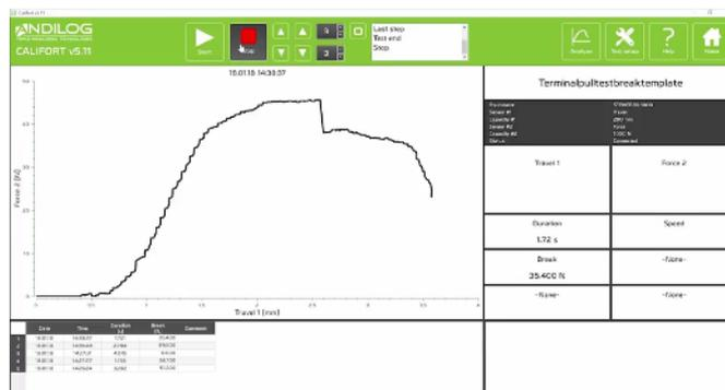
Beispiel einer Kraftmessung an der Crimpung bis zum Bruch
