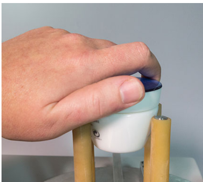
Anditork , manuelle Drehmomentmessung an Verschlüssen
