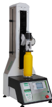
Topload , für automatisierte Messungen vom Stauchwiderstand an Flaschen
