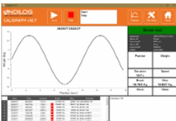
Com o software de aquisição e análise Caligraph, você pode monitorar a evolução de suas curvas de força e torque em tempo real, registrar seus dados, calcular automaticamente seus resultados e editar relatórios de teste personalizáveis.
