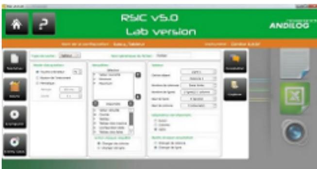
O RSIC Lab também permite programar sequências de dados a serem recuperadas quando você pressiona uma tecla no instrumento ou uma tecla no teclado do computador. Portanto, **é possível recuperar o máximo, o mínimo, a curva e a tara do instrumento de uma só vez para que ele esteja pronto para a próxima medição.**
